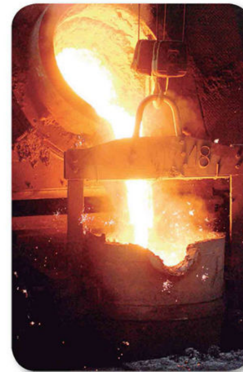
Fig. 4.41 Los hornos de fundición pueden alcanzar altas temperaturas para lograr la reacción redox que se necesita para transformar el metal.
