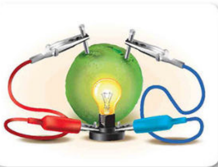
Fig. 4.4 Un limón puede producir electricidad, debido a su contenido de ácido cítrico.
